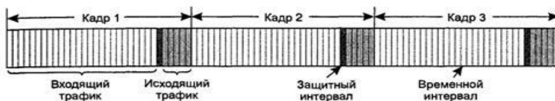
Рис.2.3 Дуплексная связь с временным разделением
