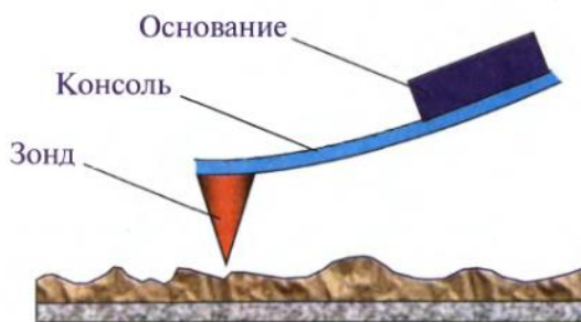
Рисунок 2 – Схема зондового датчика
