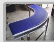
Конвейер с модульной лентой
