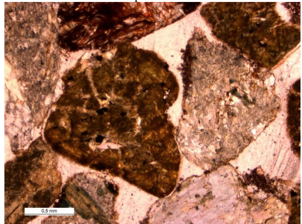
Рис.3-9. Ожелезнённые обломки эпидот-хлоритового состава. В правом нижнем углу фрагмент тремолита. Без анализатора.
