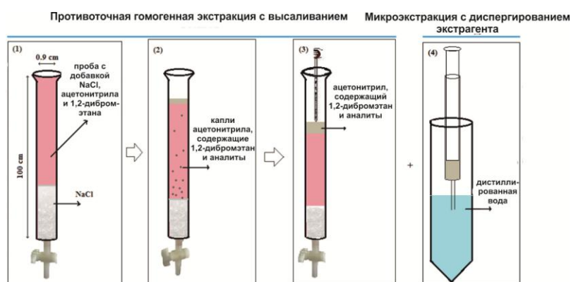
Рис.2 Схема проведения противоточной ГЖМЭ с высаливанием в комбинации с МЭ ДЭ [40]
