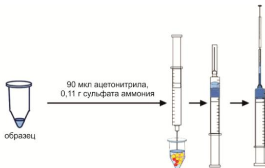
Рис.3 Схема проведения гомогенной экстракции с высаливанием с использованием шприца для отбора органической фазы [43]
