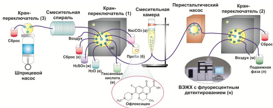
Рис.12 Аэрогидравлическая схема проточной системы, использованной для автоматизации ГЖМЭ с разделением фаз углекислым газом
