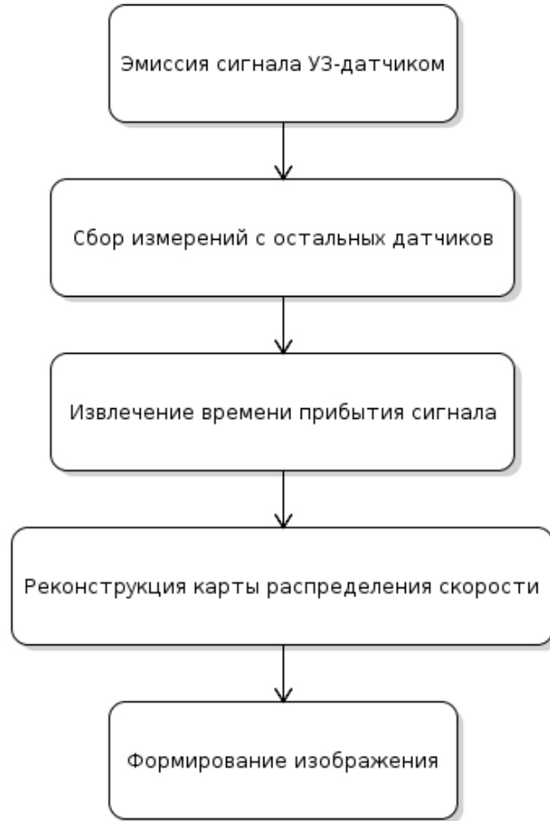
Рис. 1: Общий вид процесса ультразвуковой томографии времени прибытия.
