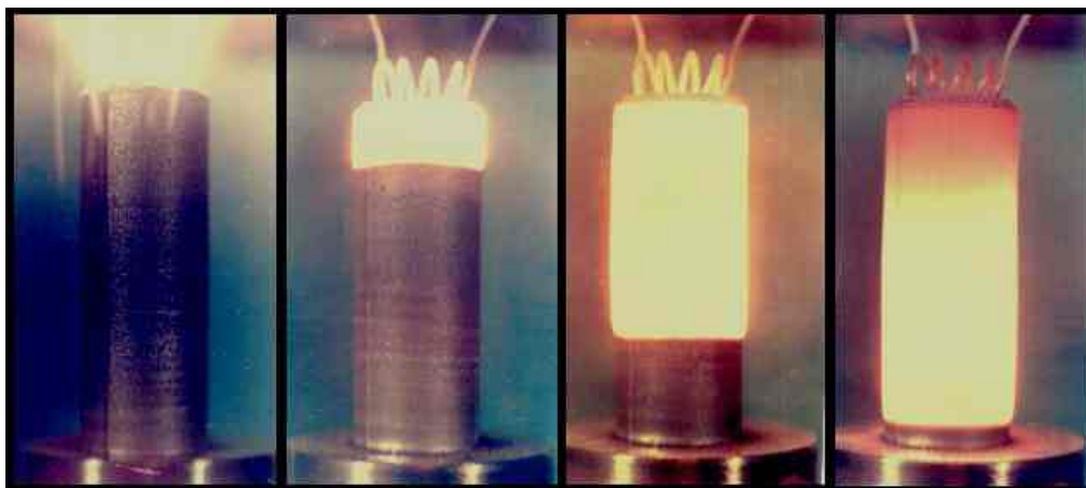
Рисунок 2. Распространение волны горения в заготовке при СВС [9].
