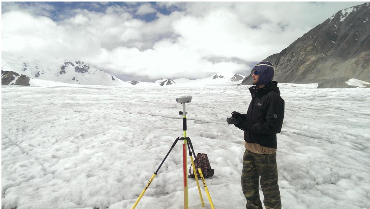
*Рис. 4. Измерение местоположения гляциологической рейки ГНСС-приёмником в режиме быстрой статики. На фотографии аспирант кафедры физической географии и ландшафтного планирования СПбГУ Терехов А.В.*
