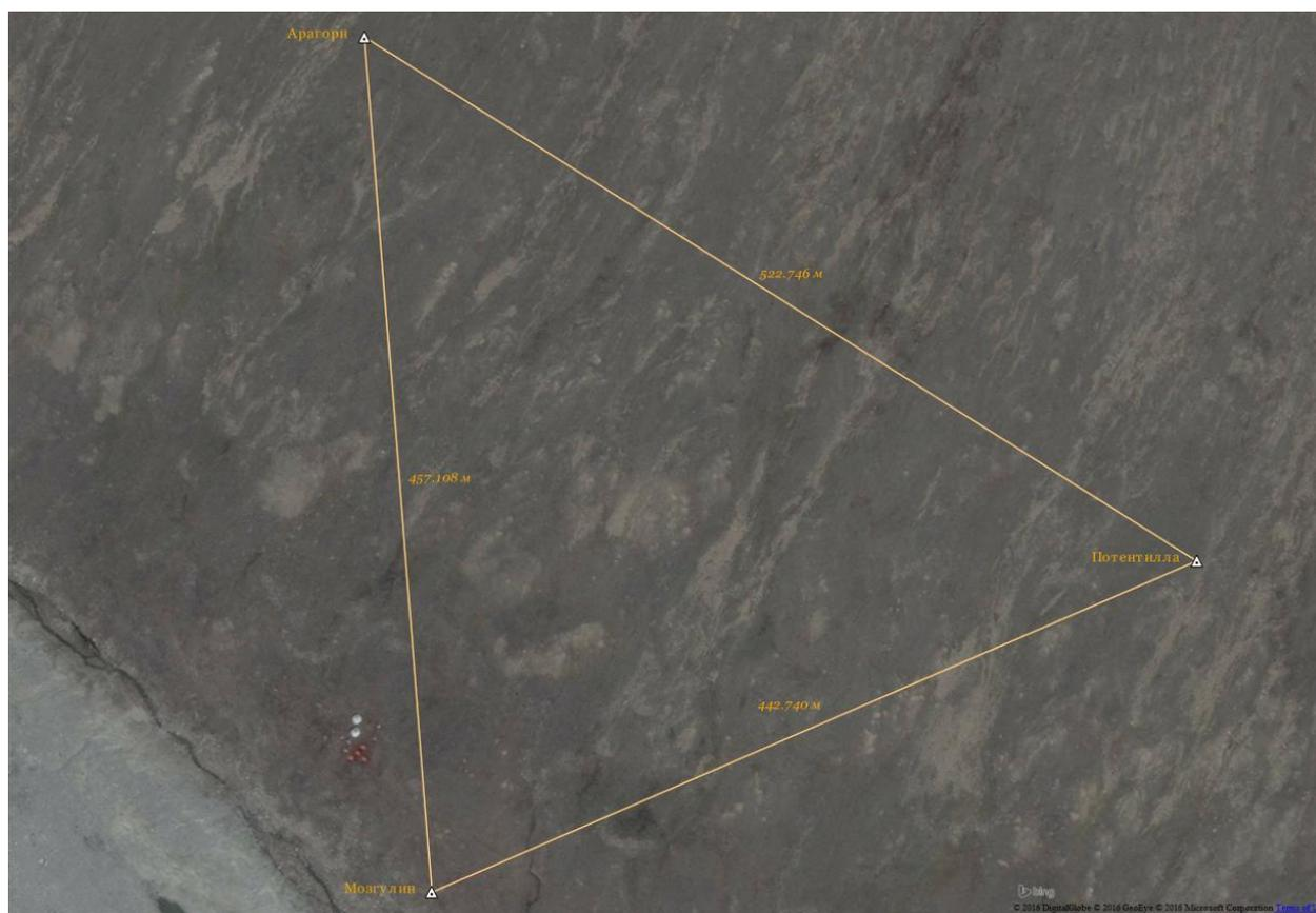
*Рис. 7. Расположение трёх геодезических пунктов «Мозгулина», «Арагорн» и «Потентилла» с указанием эллипсоидального расстояния в июне между ними.*
