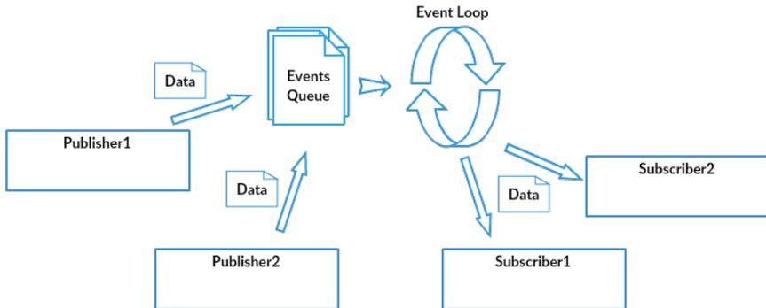
Рис. 7: Механизм исполнения потоковой программы в TRIK Studio
