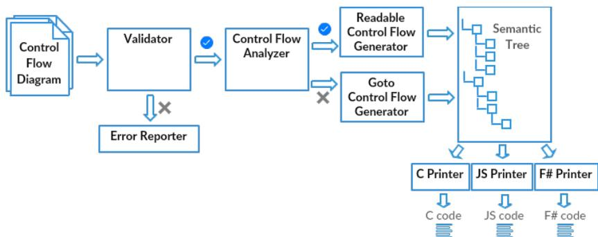
Рис. 8: Архитектура подсистемы генерации кода в TRIK Studio
