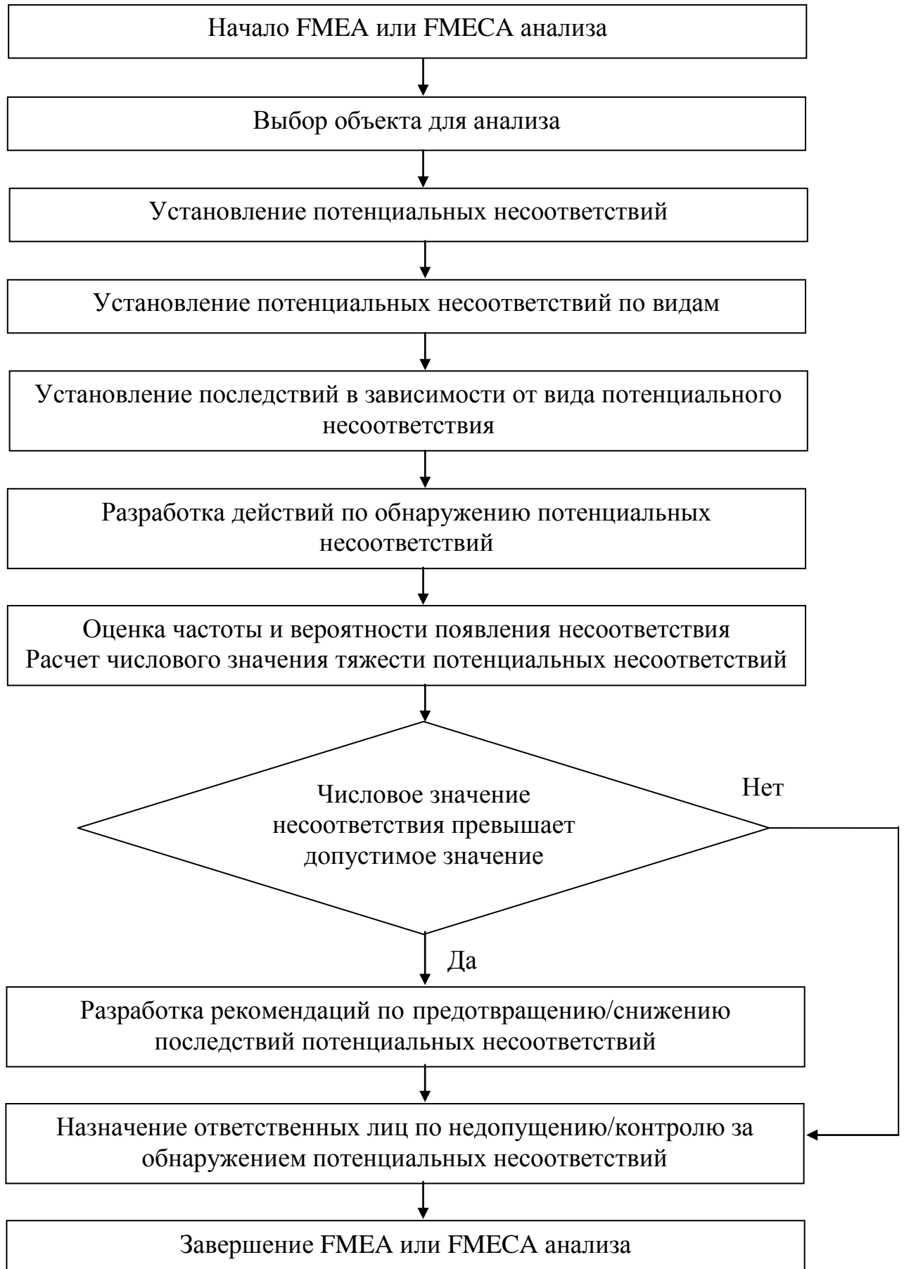
Рисунок 1 – Блок-схема FMEA/FMECA анализа
