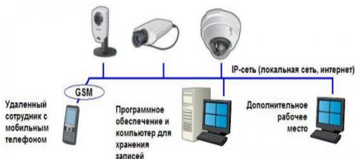
Рисунок 2.2 - Типовая структура системы IP-видеонаблюдения
