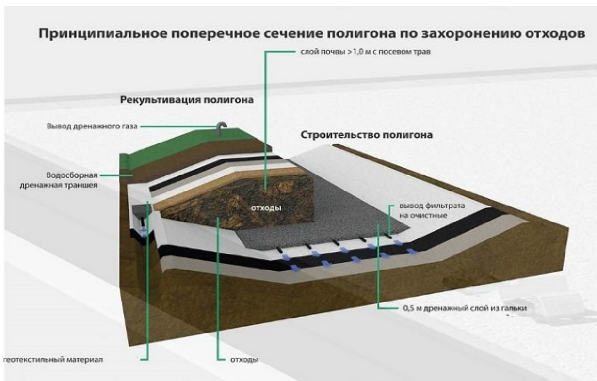
Рисунок 2. Принципиальное поперечное сечение полигона по захоронению отходов
