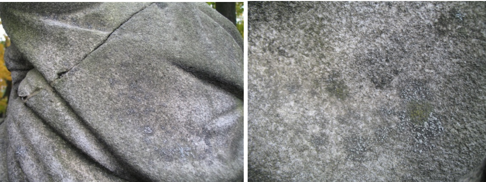
Рис. 4 Слоевища накипных лишайников и колонии темноокрашенных грибов на поверхности мрамора статуи.
