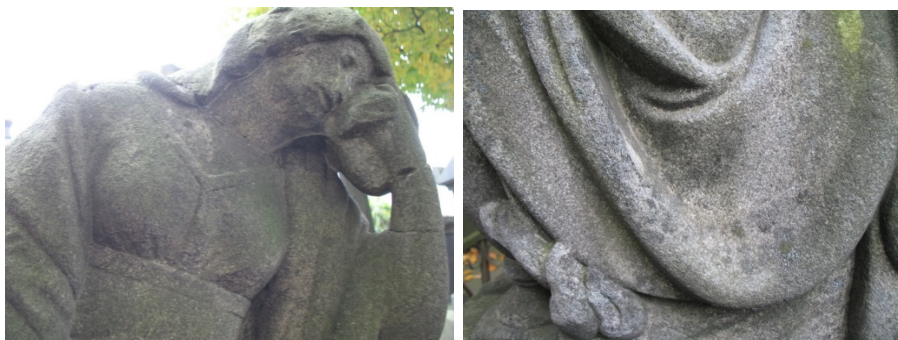
Рис.2. Биопленка на поверхности мрамора статуи, состоящая из колоний темноокрашенных грибов, слоевищ лишайников и налета водорослей.
