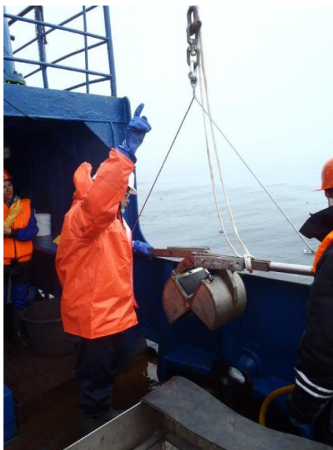
Рисунок 2.2 - Отбор проб дночерпателем Ван-Вина с борта НИС "Дальние Зеленцы", море Лаптевых, сентябрь 2014 г. (фото из архива И.А.Стогова)
