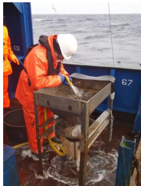
Рисунок 2.3 - Промывка дночерпательных проб на борту НИС "Дальние Зеленцы", море Лаптевых, сентябрь 2014 г. (фото из архива И.А.Стогова)
