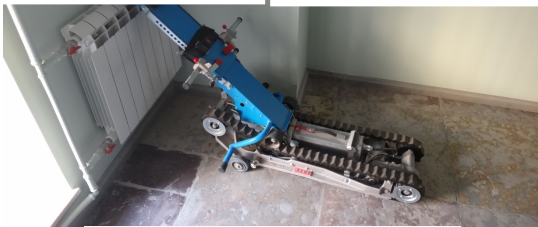
Рис. Д.21 Подъемное устройство на аккумуляторах
