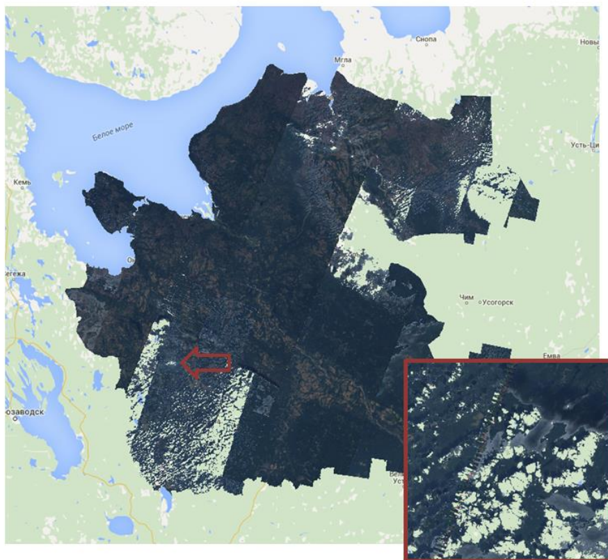
Рисунок 4.4 - создание безоблачного композита, используя метод ee.Algorithms.Landsat.simpleCloudScore , справа - не все облака были удалены с помощью данного метода
