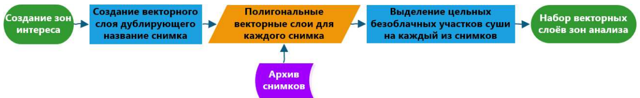
Рисунок 46. Блок-схема процесса определения зон анализа каждого из снимков
