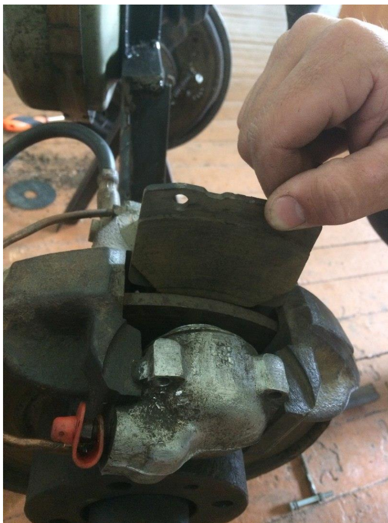
Рисунок 9 - Извлечение тормозной колодки
