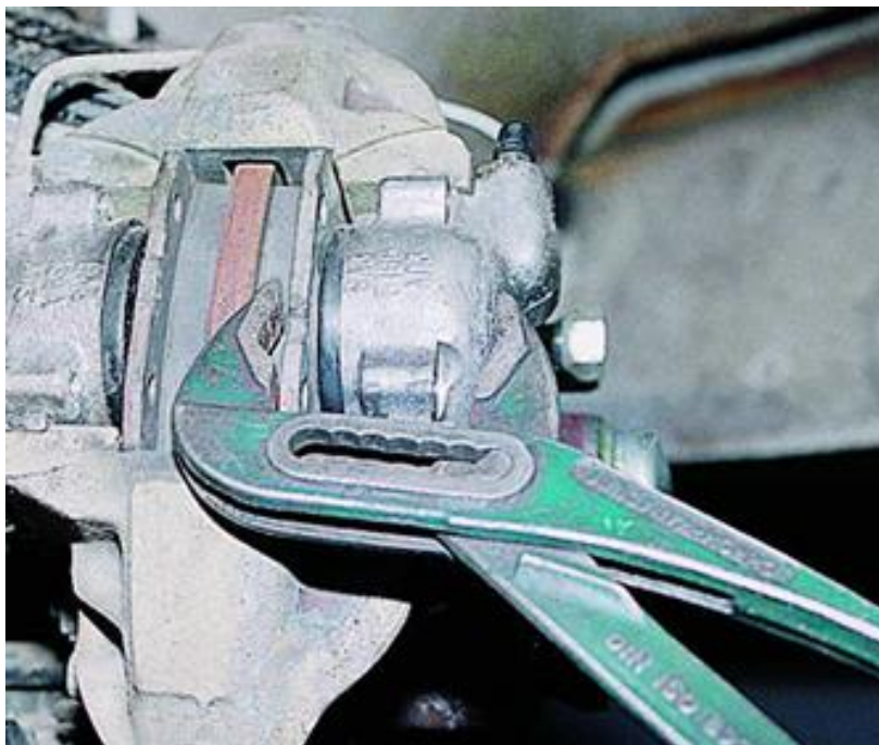
Рисунок 8 - Утапливание поршней в цилиндры
