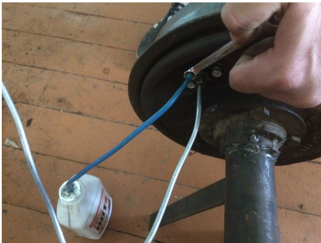
Рисунок 5 – Слив тормозной жидкости заднего колесного цилиндра
