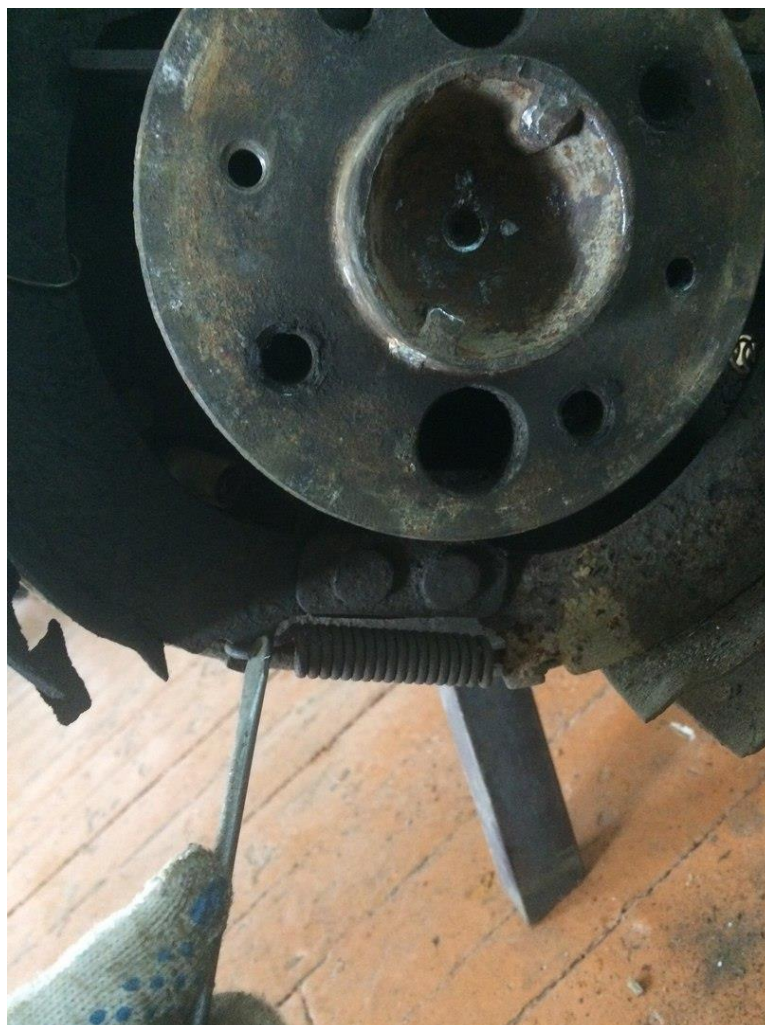
Рисунок 8 - Снятие с опоры нижней части тормозных колодок
