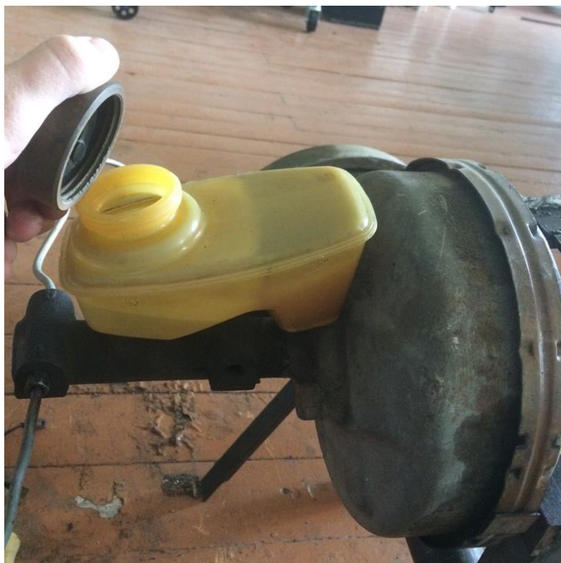
Рисунок 2 – Снятие крышки тормозного бачка
