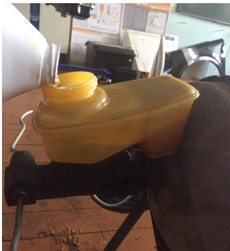
Рисунок 3 – Доливка новой тормозной жидкости
