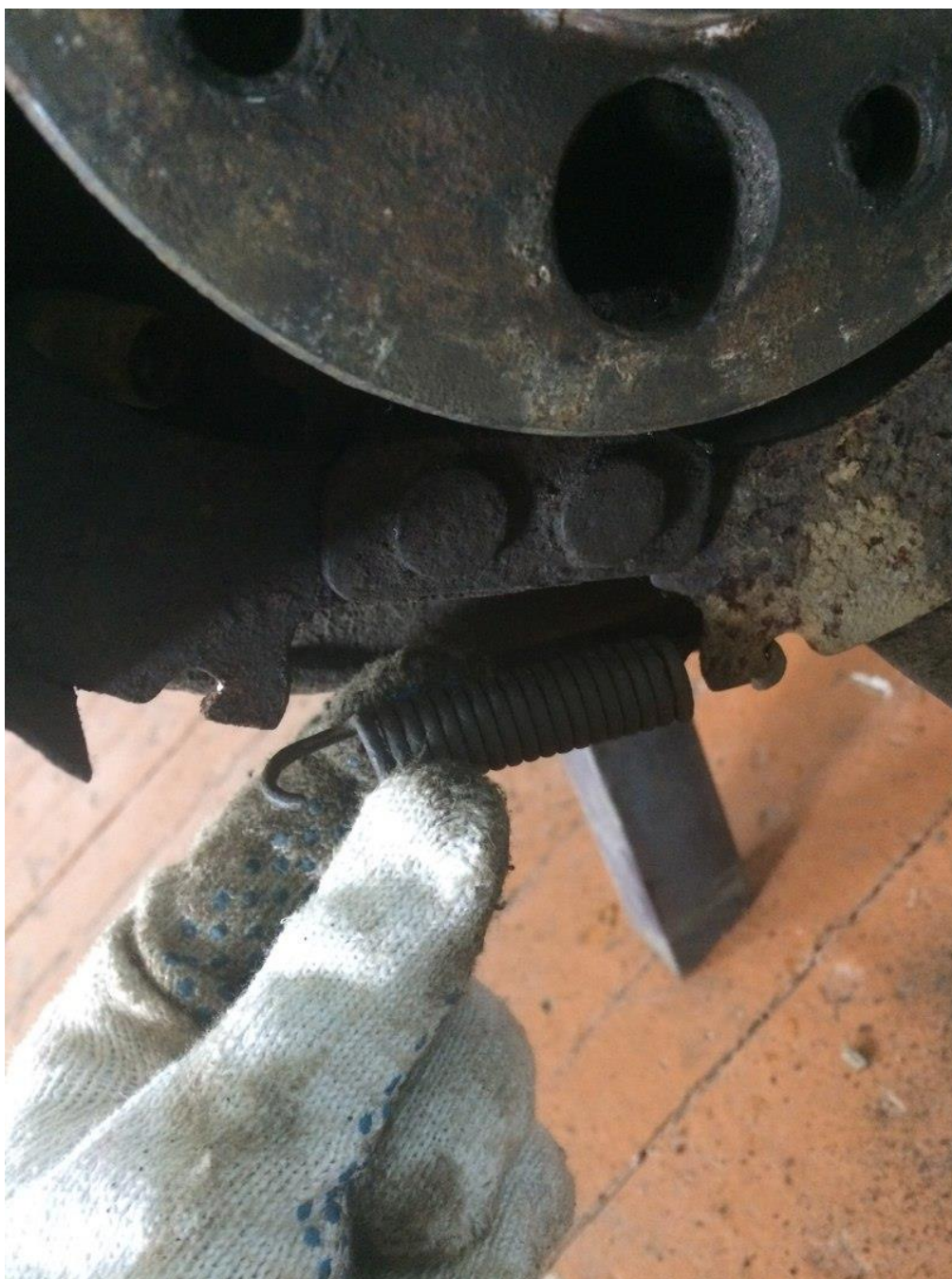
Рисунок 9 - Снятие нижней стяжной пружины
