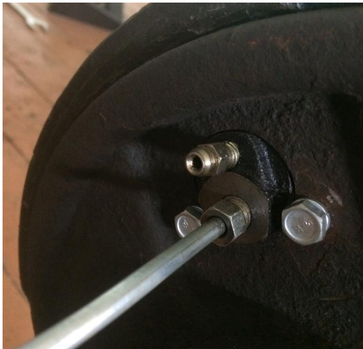
Рисунок 4 – Штуцер для выпуска воздуха заднего колесного цилиндра
