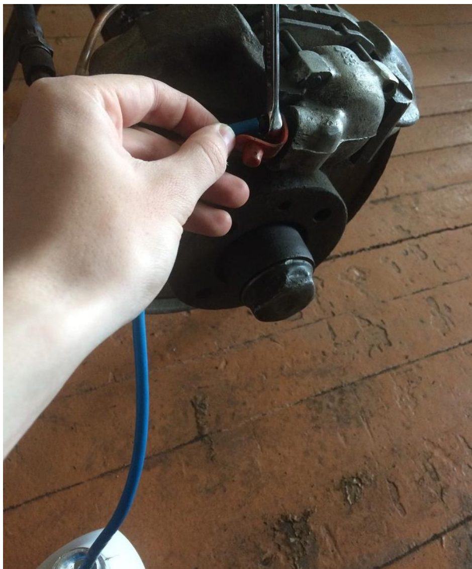
Рисунок 7 – Слив тормозной жидкости переднего колесного цилиндра
