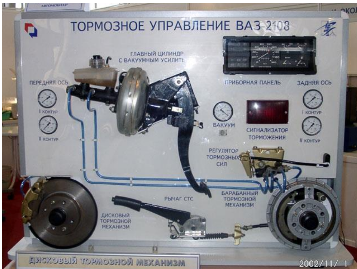
Рисунок 1.1 – Стенд тормозной системы автомобиля ВАЗ-2108
