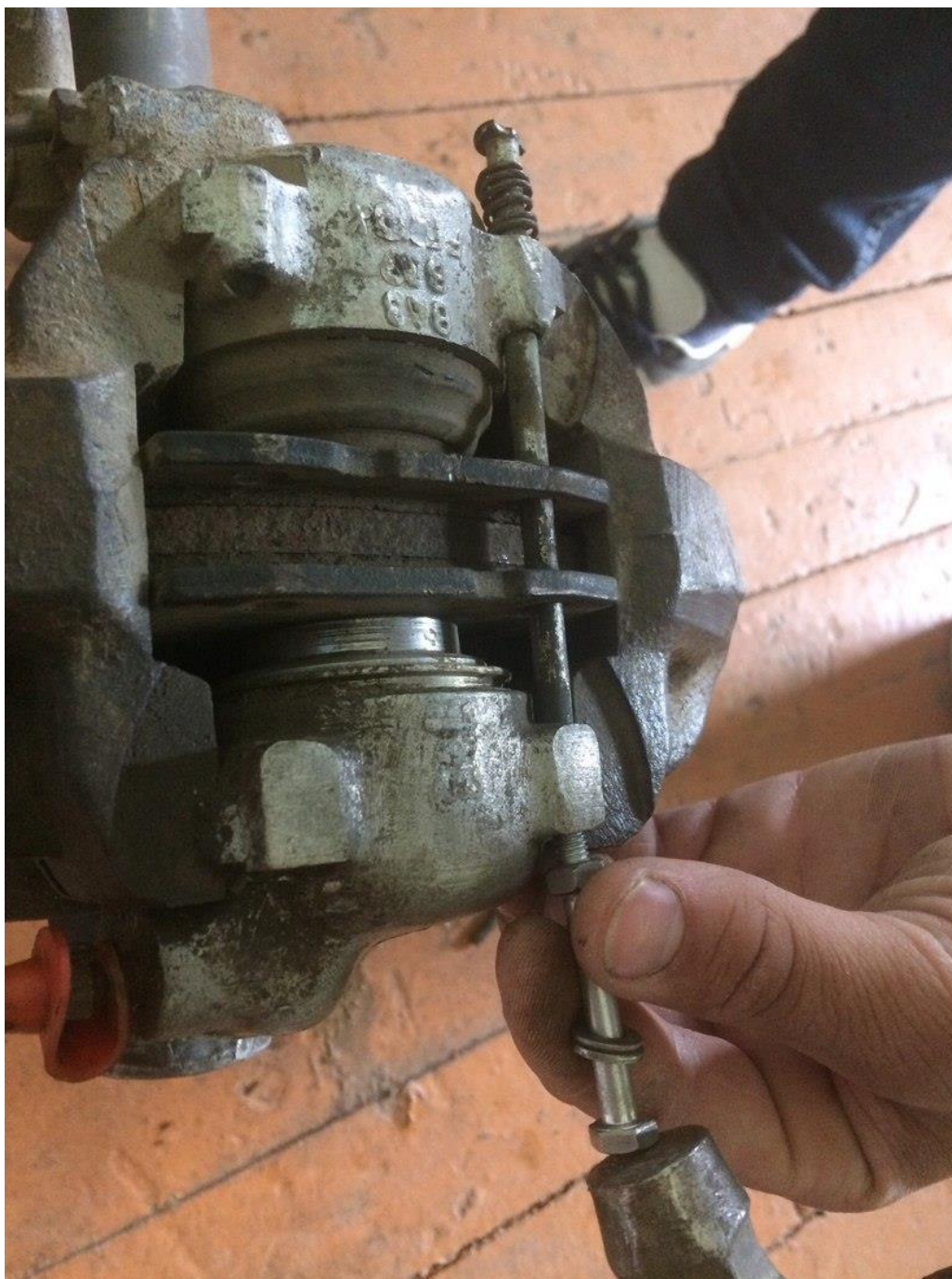
Рисунок 7 – Выбивание пальцев из проушин
