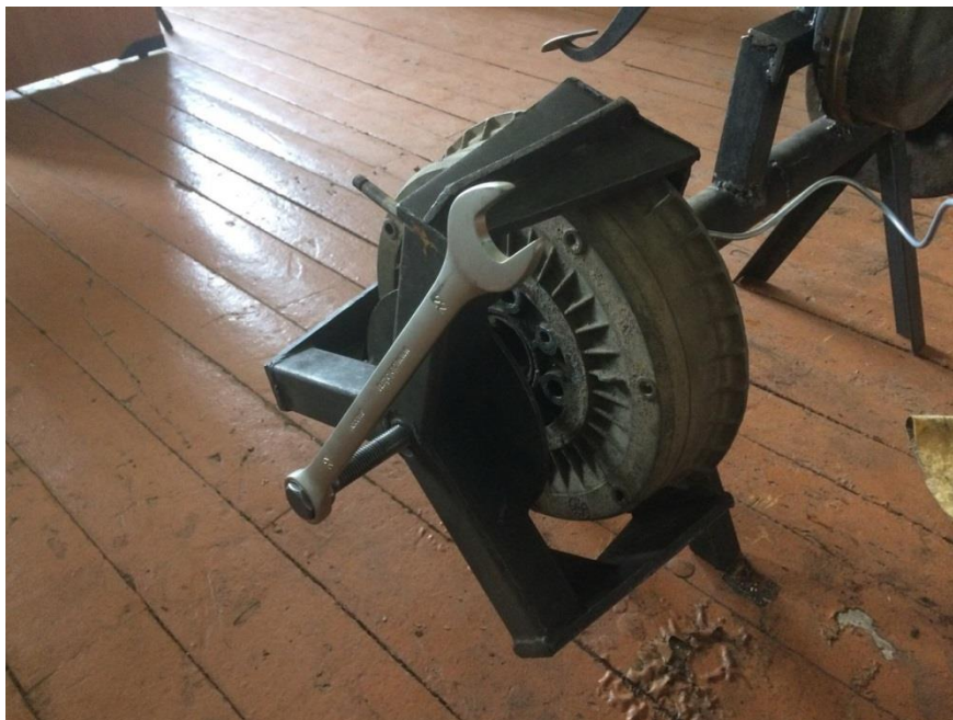
Рисунок 7 – Снятие тормозного барабана
