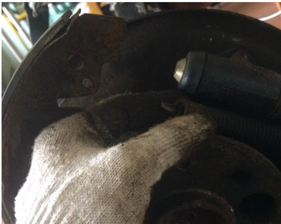
Рисунок 11 - Снятие верхней стяжной пружины
