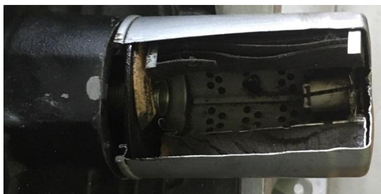
Рисунок 3.9 – Масляный фильтр с выпиленным разрезом.
