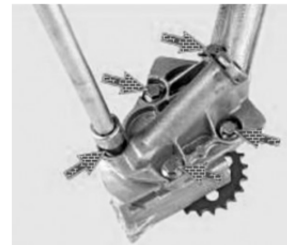
Рисунок 3 – Болты крепления крышки масляного насоса
