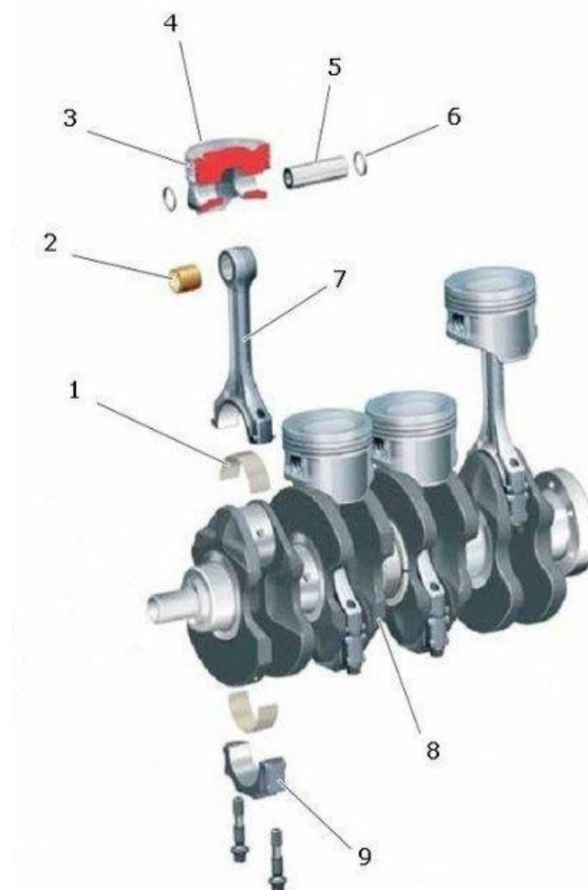
Рисунок 2.2 – Схема кривошипно-шатунного механизма:
