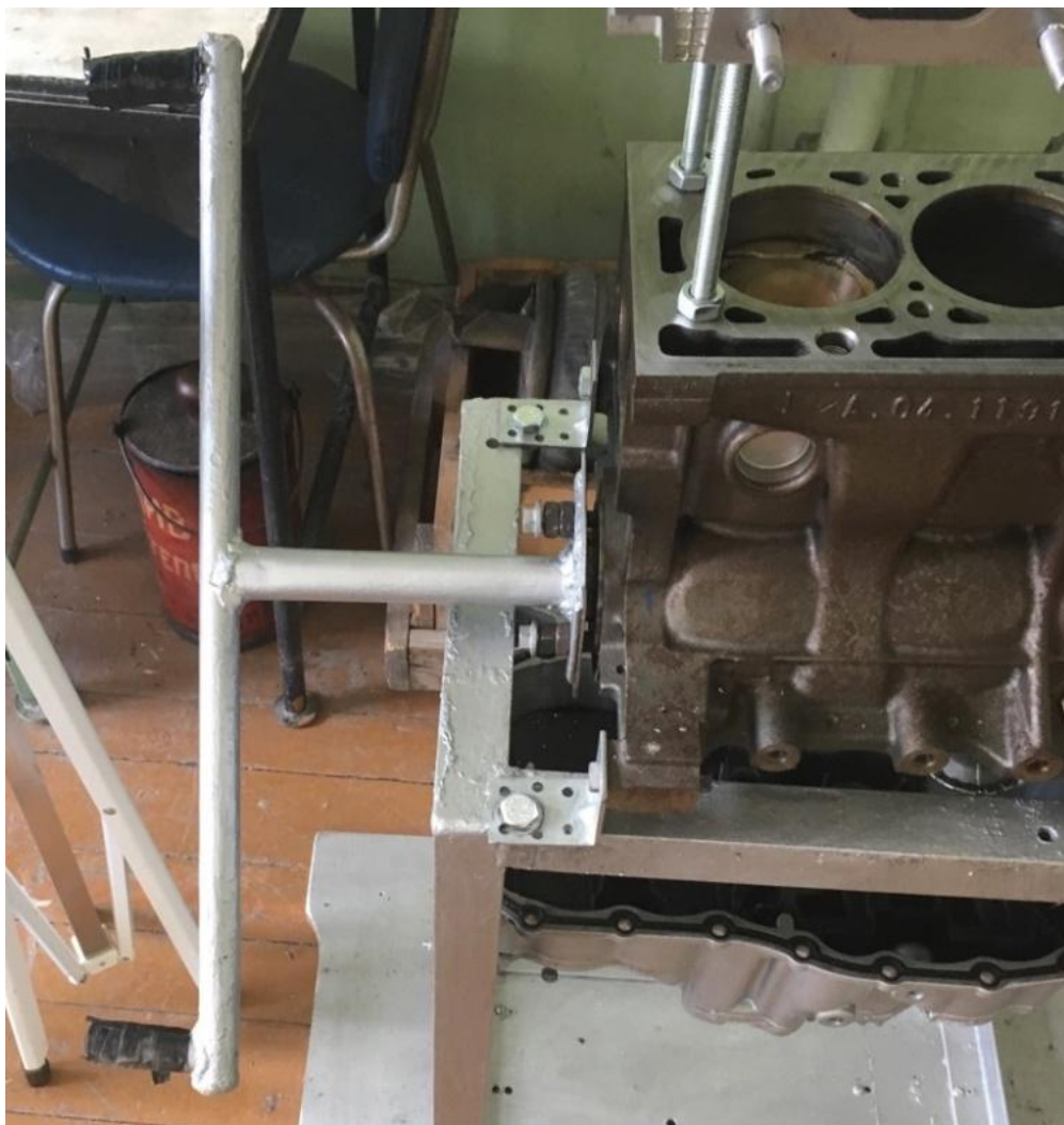
Рисунок 3.7 – Ручка вращения коленчатого вала.
