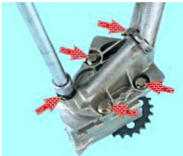
Рисунок 4.12 – Болты крепления крышки масляного насоса
