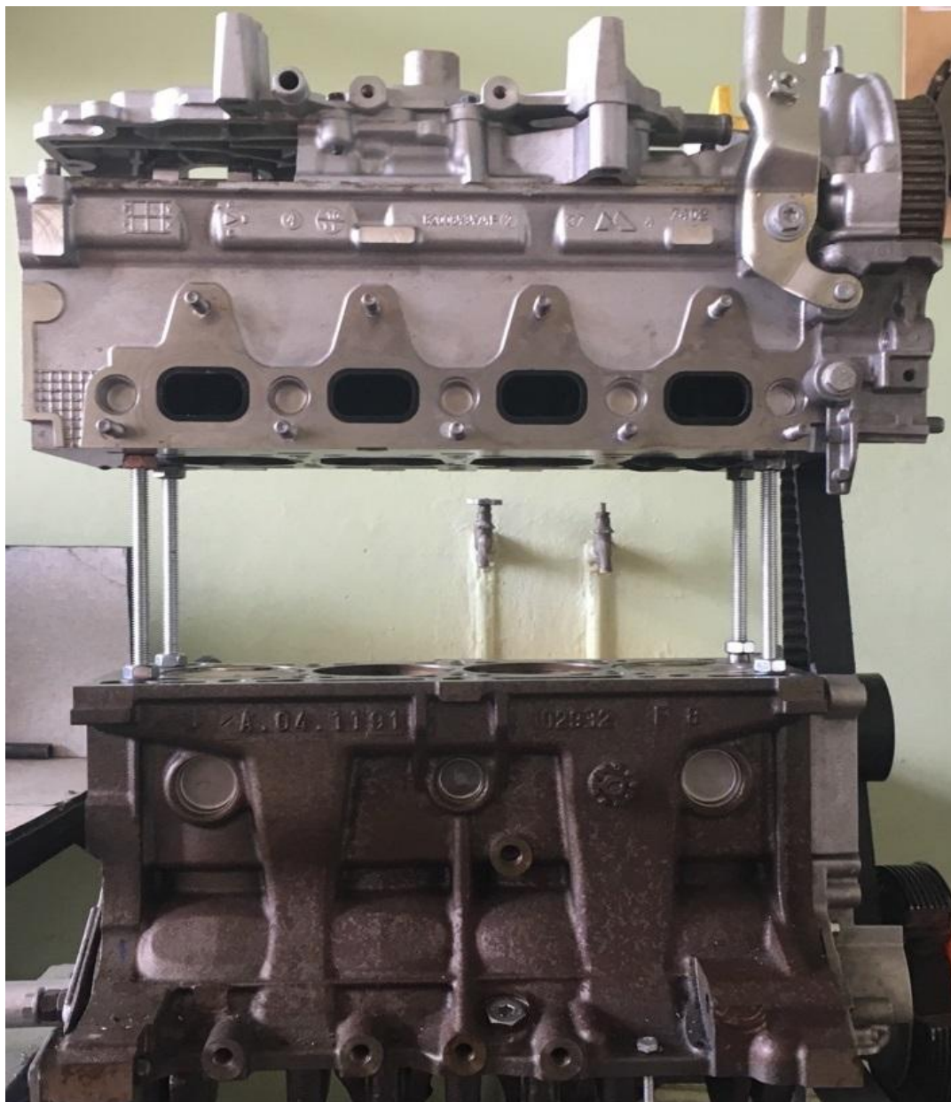
Рисунок 3.6 – Головка блока цилиндров, установленная на блок.
