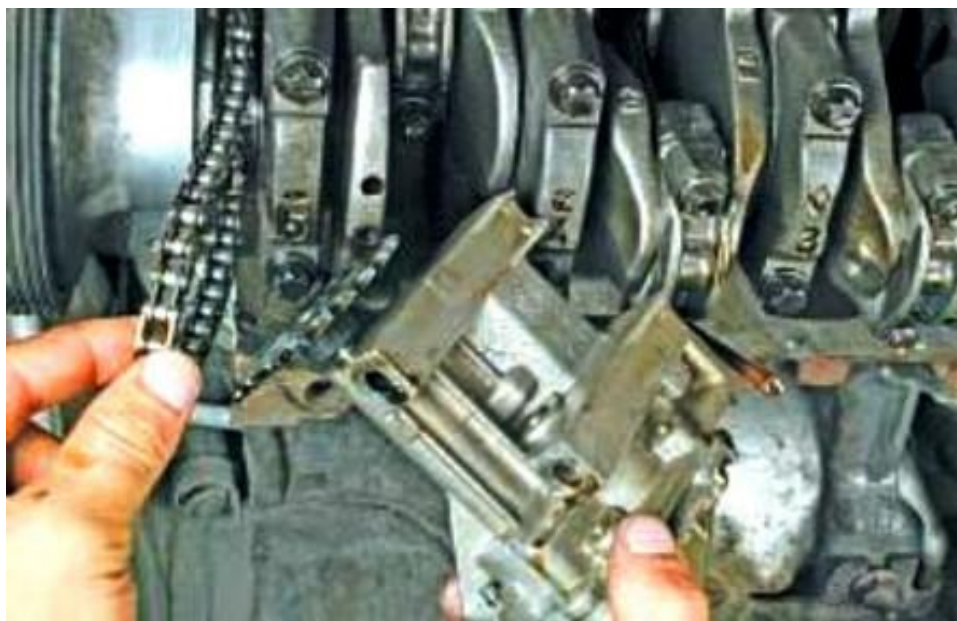
Рисунок 4.11 – Снятие масляного насоса
