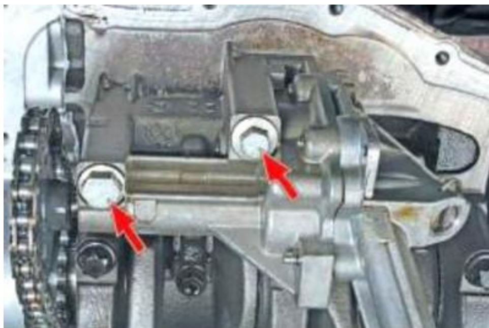
Рисунок 4.10 – Болты крепления масляного насоса
