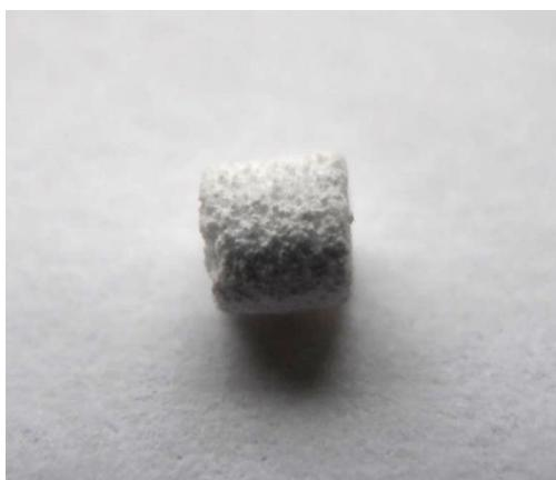
Рис. 7. Образец композиционного материала из фосфатов кальция полученный методом поверхностно-селективного лазерного спекания, с высокотемпературным отжигом
