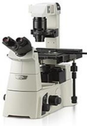
Рис. 10. Инвертированный оптический микроскоп Eclipse Ti-S
