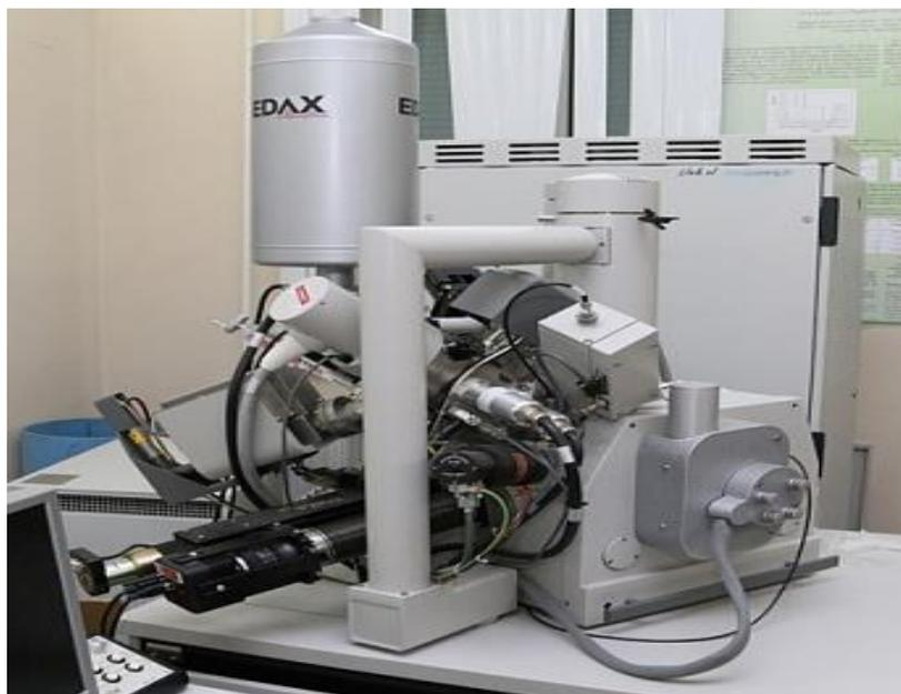
Рис. 11. Растровый электронный микроскоп Quanta 200 3D фирмы FEI
