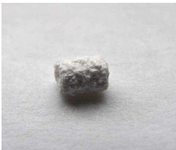
Рис. 8. Образец композиционного материала из фосфатов кальция полученный методом трехмерной печати, с высокотемпературным отжигом
