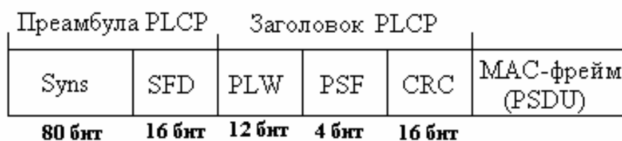
Рисунок 1.4 - Формат фрейма FSSS подуровня PLCP стандарта 802.11
