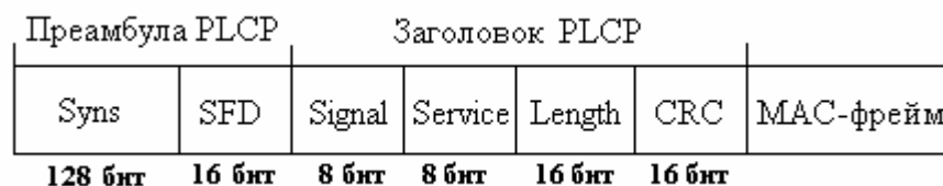
Рисунок 1.5 - Формат фрейма DSSS PPDU подуровня PLCP стандарта 802.11
