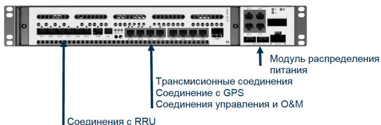
Рисунок 5.8 – Основной модуль RBS 6601 с DUW, внешний вид
