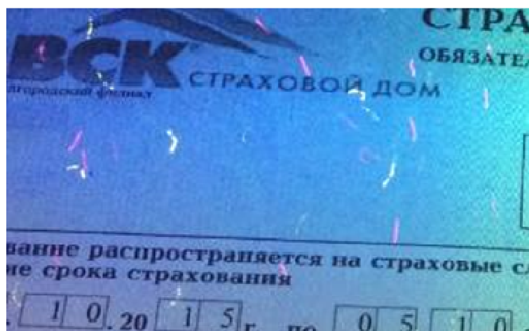
Рис. 3. Защитные волокна, видимые в УФ-лучах, на бланке полиса ОСАГО образца 2014 года
