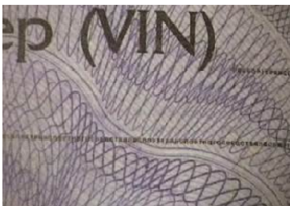
Рис. 4. Гильоширная розетка, выполненная с помощью ирисового раската, на бланке ПТС образца 1997 года
