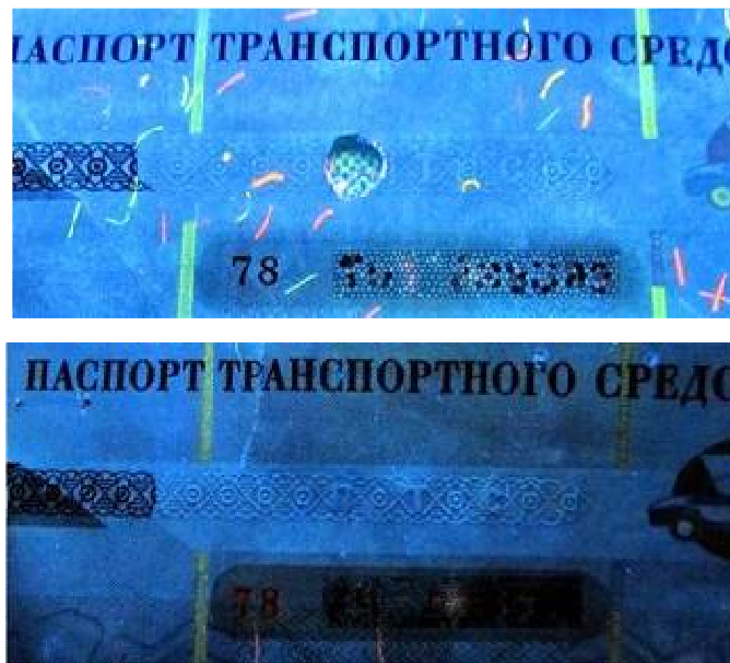
Рис. 10. Люминисценция фрагмента бланка ПТС, образца 2005 года (сверху-бланк ПТС, изготовленный ФГУП «Гознак»; снизу-поддельный бланк ПТС)
