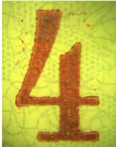
Рис. 21. Увеличенный фрагмент серийного номера водительского удостоверения образца 2011 года, выполненного с помощью прямой высокой печати
