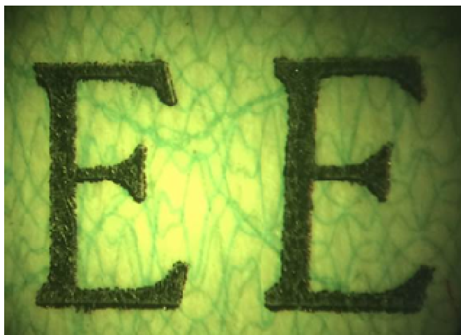
Рис. 5. Фрагмент серийного номера, выполненный с помощью прямой высокой печати, на бланке полиса ОСАГО образца 2014 года
