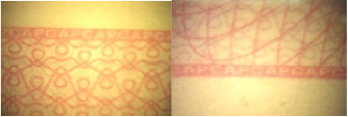
Рис. 14. Увеличенный фрагмент микротекста, выполненный в верхней (слева) и нижней части (справа) бланка полиса
