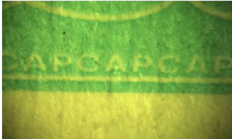
Рис. 6. Фрагмент микротекста на бланке полиса ОСАГО образца 2014 года
