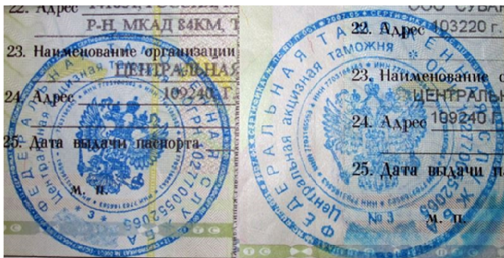
Рис. 2. Разница в размере оттиска печати центральной Акцизной таможни на бланках ПТС (слева – поддельный оттиск, справа – выполненный с помощью поддельного клише).
