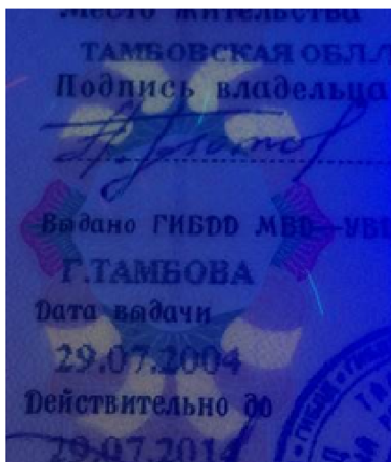
Рис. 6. Свечение гильоширного рисунка, на бланке водительского удостоверения №1 образца 2000 года
