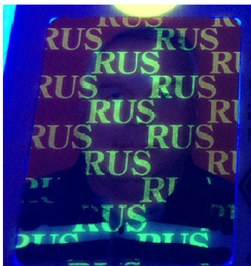
Рис. 12. Видимый в ультрафиолетовых лучах текст отличительного знака Российской Федерации «RUS» на бланке водительского удостоверения №2 образца 2000 года
