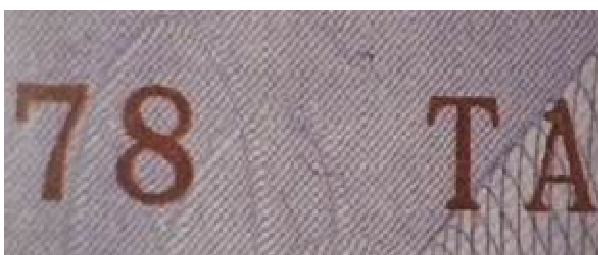
Рис. 5. Фрагмент серийного номера, выполненный с помощью типоофсета, на бланке ПТС образца 1997 года
