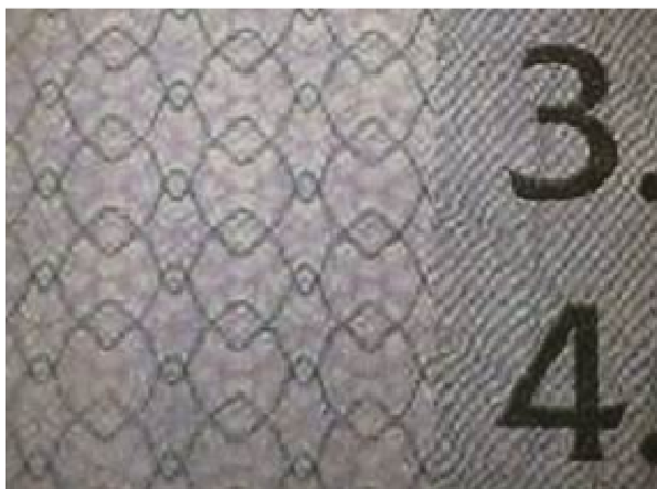
Рис. 3. Защитная сетка, выполненная офсетным способом печати, на бланке ПТС образца 1997 года
