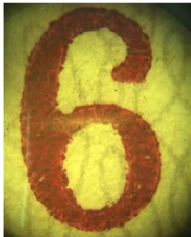
Рис. 7. Фрагмент цифровой серии и шестизначного номера свидетельства, напечатанный с помощью прямой высокой печати
