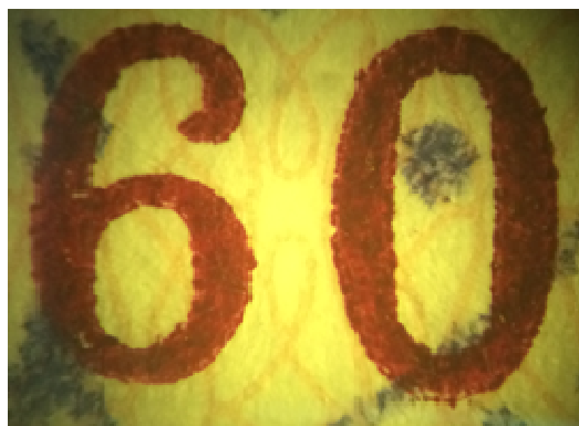
Рис. 5. Фрагмент серийного номера, выполненный с помощью прямой высокой печати, на бланке водительского удостоверения №1 образца 2000 года
