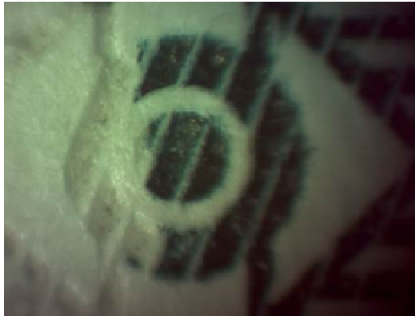
Рис. 19. Фрагмент орнаментной полосы, выполненной металлографической печатью на бланке ПТС образца 2005 года
