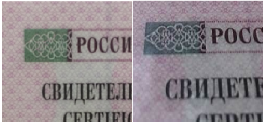
Рис. 9. Орнамент, выполненный OVI-краской, который меняет цвет от зеленого до серого под разными углами освещения
