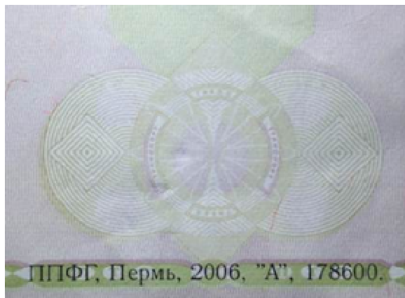
Рис. 14. Гильоширная розетка, выполненная на бланке ПТС образца 2005 года
