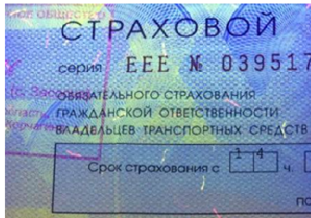
Рис. 16. Свечение фрагмента бланка ОСАГО образца 2016 года в УФ-лучах
