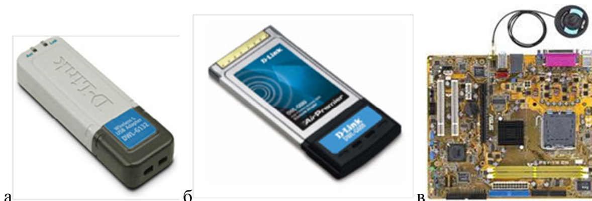
Рисунок 2.13 - Беспроводные адаптеры: а – с USB портом, б – формата PCMCIA, в – встроенный в материнскую плату
