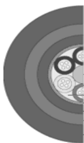
Рисунок 3.21 – Волоконно-оптический кабель СПЛ-06-8Е 9,5/125
