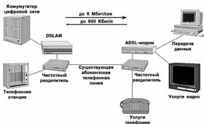
Рисунок 2.1 – Принцип работы DSL-сети абонентского доступа АТС-33
