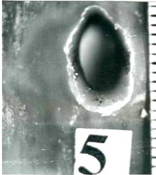
Рис. 3. Огнестрельное повреждение поверхности биоимитатора пулей 5,6 мм патрона на дистанции 30 мм, выстреленной из самодельного гладкоствольного оружия с большим (+ 0,2мм) калибром канала ствола
