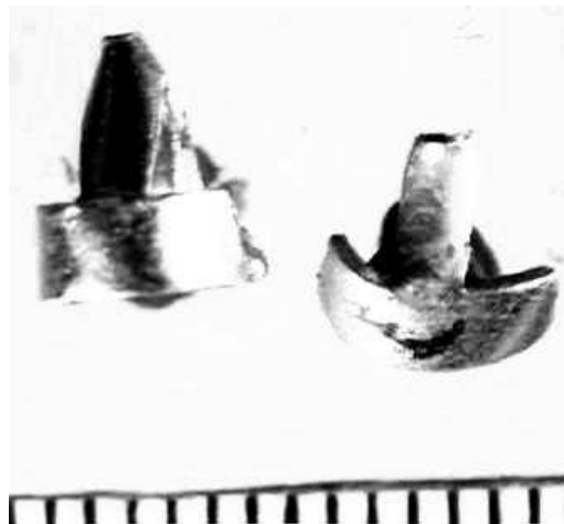
Рис. 1. Два фрагмента от оболочки пули, выстреленной из самодельного огнестрельного оружия, имеющего дефекты канала ствола
