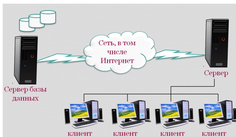
Рис 2.1. Место базы данных в архитектуре клиент-сервер
