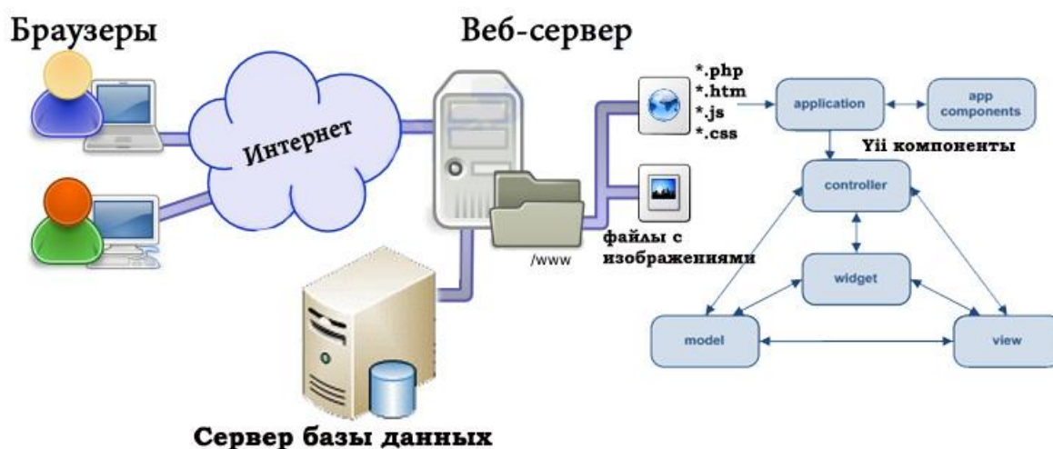
Рис. 1.2. Архитектурная схема Web-приложения
