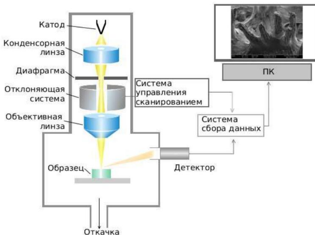
Рисунок 14 – Принципиальная схема СЭМ
