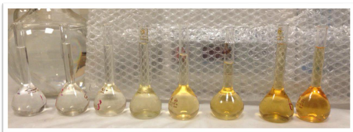
Рис. 3.5. Ряд стандартных градуировочных растворов для градуировки спектрофотометра на определение концентрации аммиака и ионов аммония в суммарной массе (фото автора)
