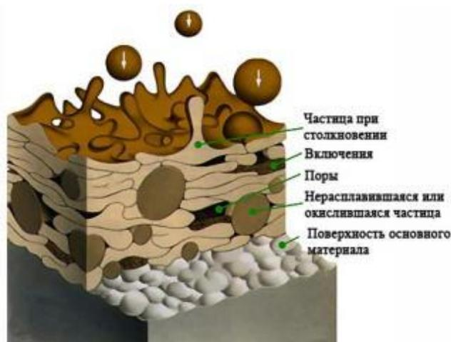
Рисунок 1.6. – Схематическое представление структуры покрытия, формирующейся в процессе обработки
