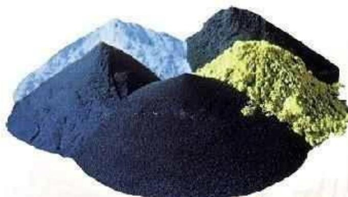
Рисунок 1.3. Порошки для напыления
