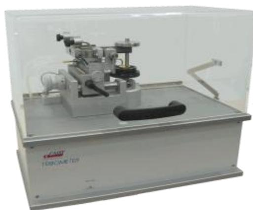
Рисунок 2.3. - Автоматизированная машина трения High-Temperature Tribometer (SCM Instruments)
