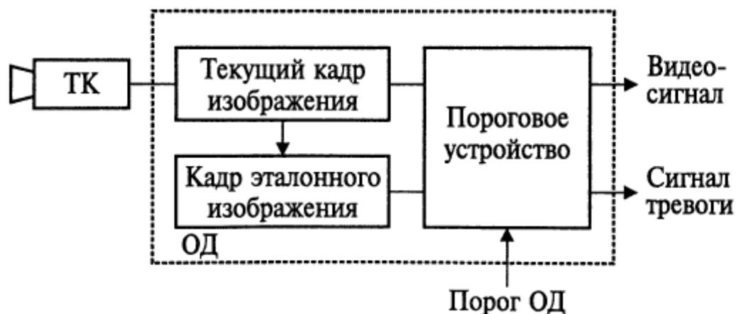
Рисунок 2.2 – Принцип работы обнаружителя движений
