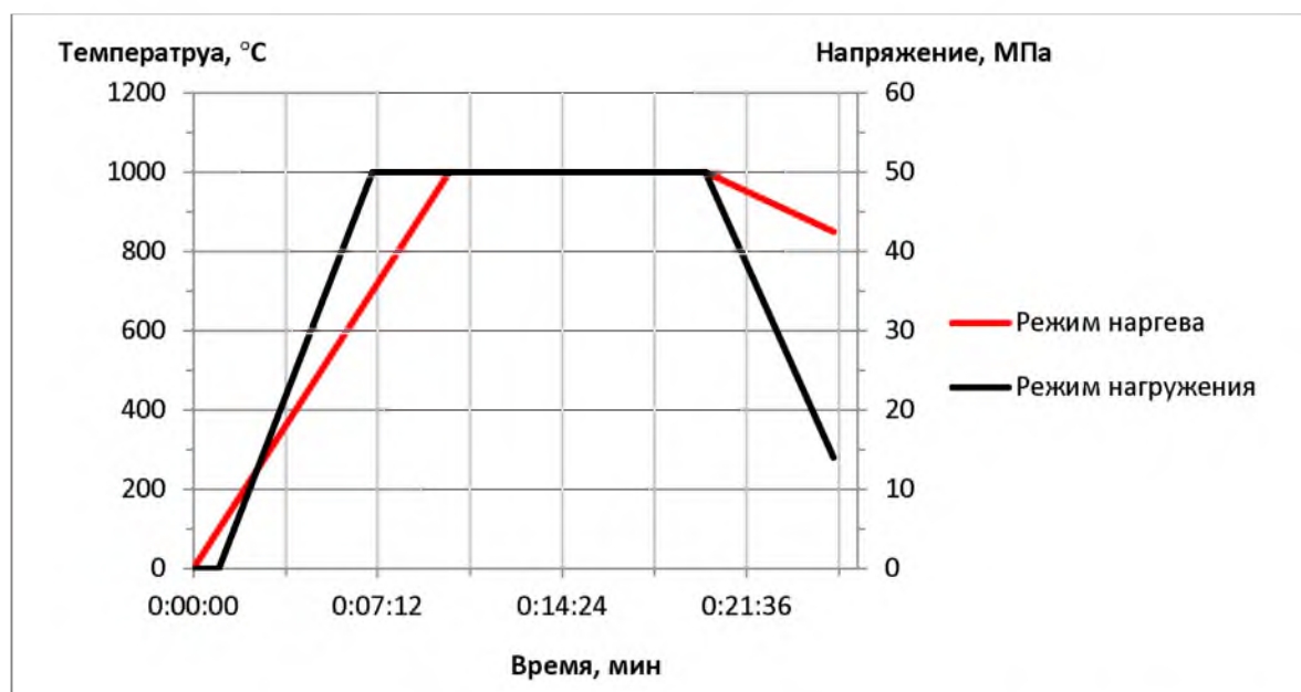
Рис. 2.4 Режим компактирования порошка на оборудовании SPS10-3
