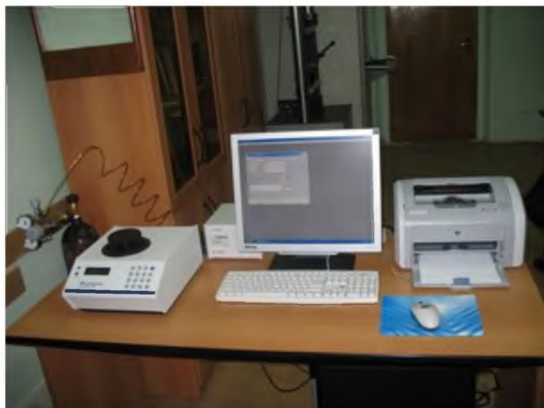
Рис. 2.6 Гелиевый пикнометр AccuPyc II 1340
