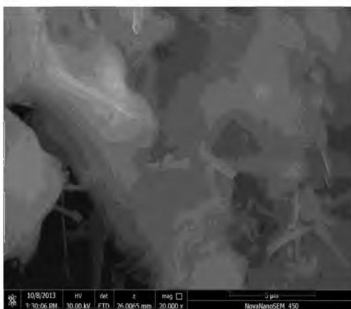
Рис. 4.4 а) РЭМ изображение ZrO(OH)_2-SiC_w после осаждения; б) РЭМ изображение агломерата порошка системы (Zr_{0.94}Y_{0.06})O_{1.88}/SiC_w
