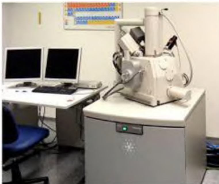
Рис. 2.5 Растровый электронный микроскоп Quanta 200 3D
