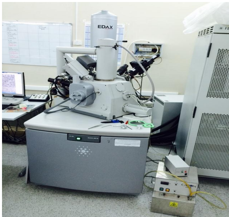
Рисунок 13. Растровый электронный микроскоп Quanta 200 3D №AL40-D8069
