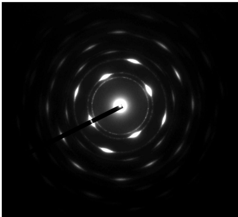
Рисунок 23. Электронограмма покрытия Ti:V, полученная в режиме дифракции с помощью ПЭМ JEM 2100
