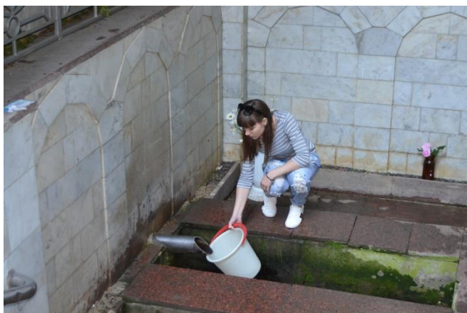
Рис. 2.2. Определение дебита на роднике Корсунской Иконы Божьей Матери, Монастырский лес, Белгородский район (фото из личного архива Стороженко Е.А.).
