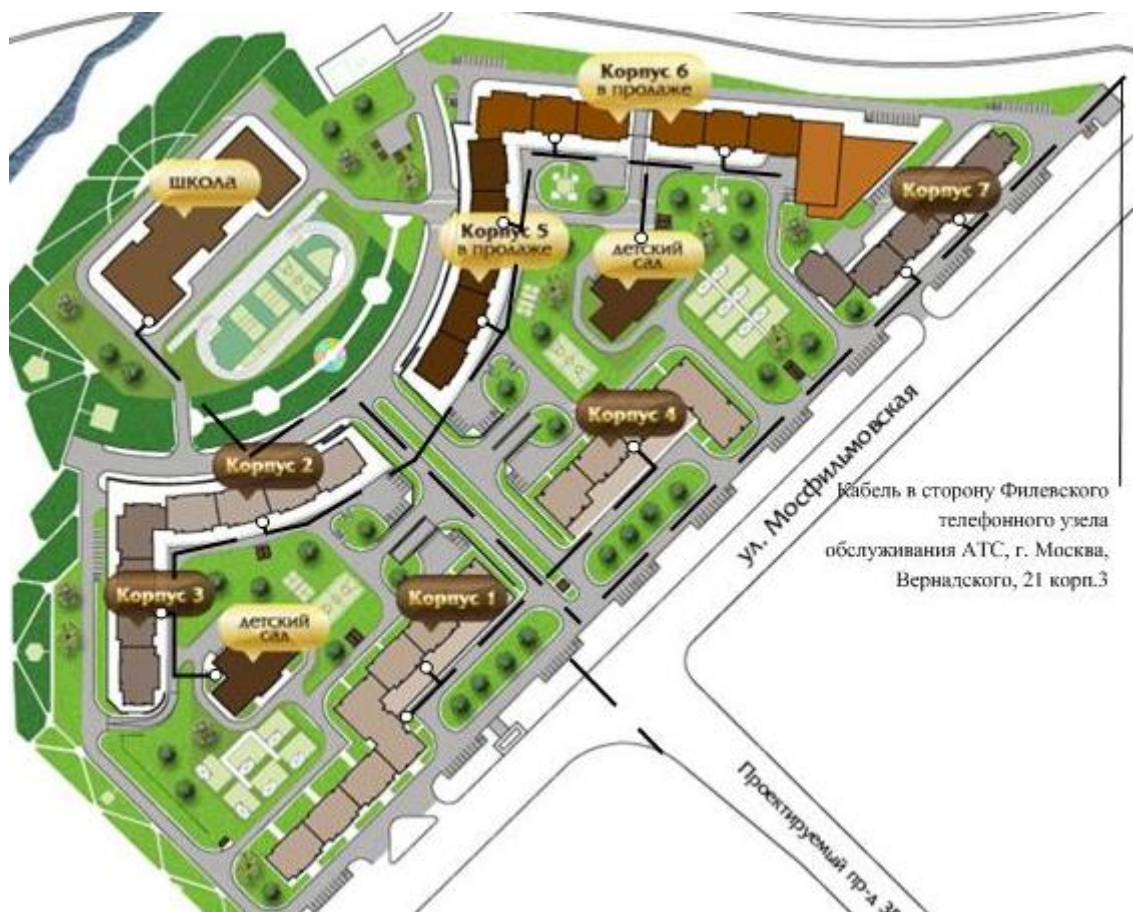
Рисунок 4.7 – Ситуационная схема трассы прокладки кабеля.
