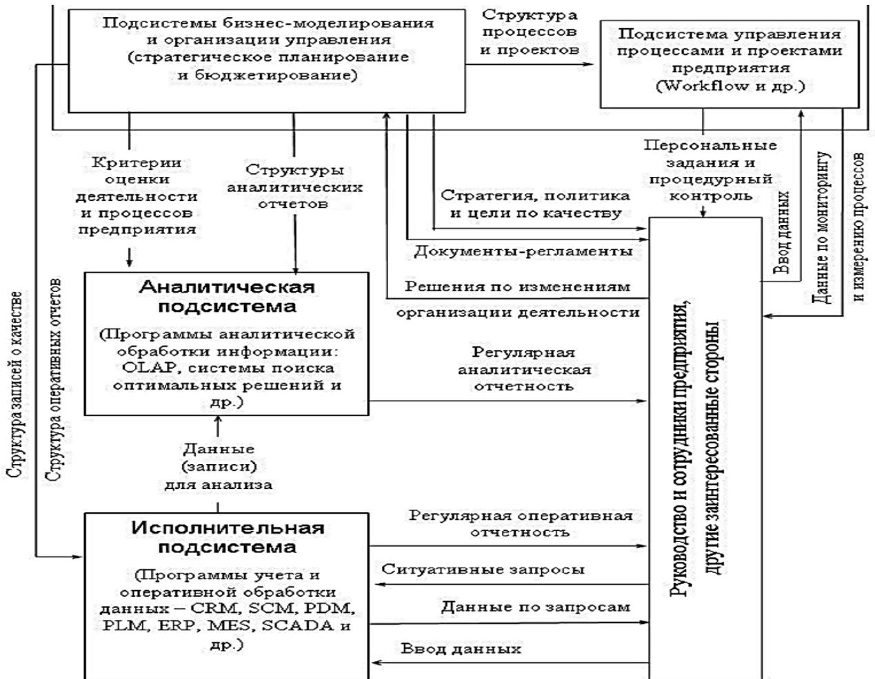
**Рисунок 2.3.2 – Структура автоматизированной СМК и механизмы ее информационного обеспечения**
