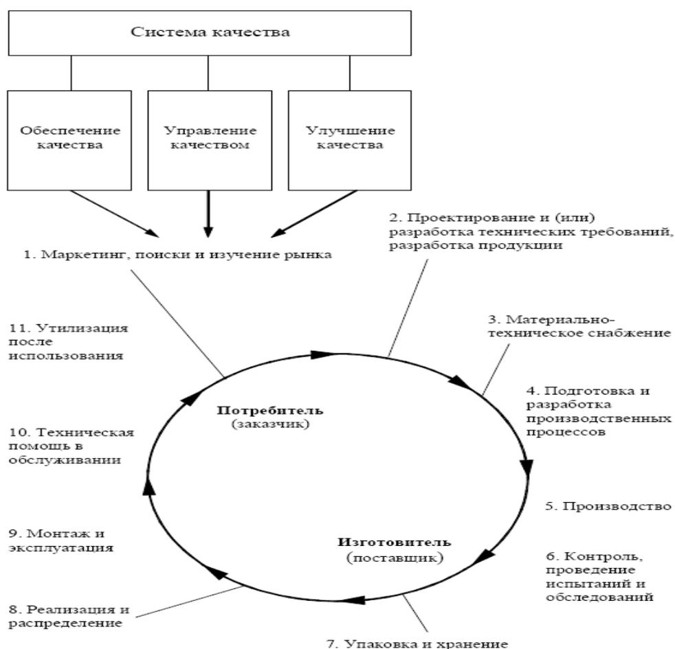
**Рисунок 1.1.1–Этапы жизненного цикла, учитываемые при функционировании системы управления качеством**
