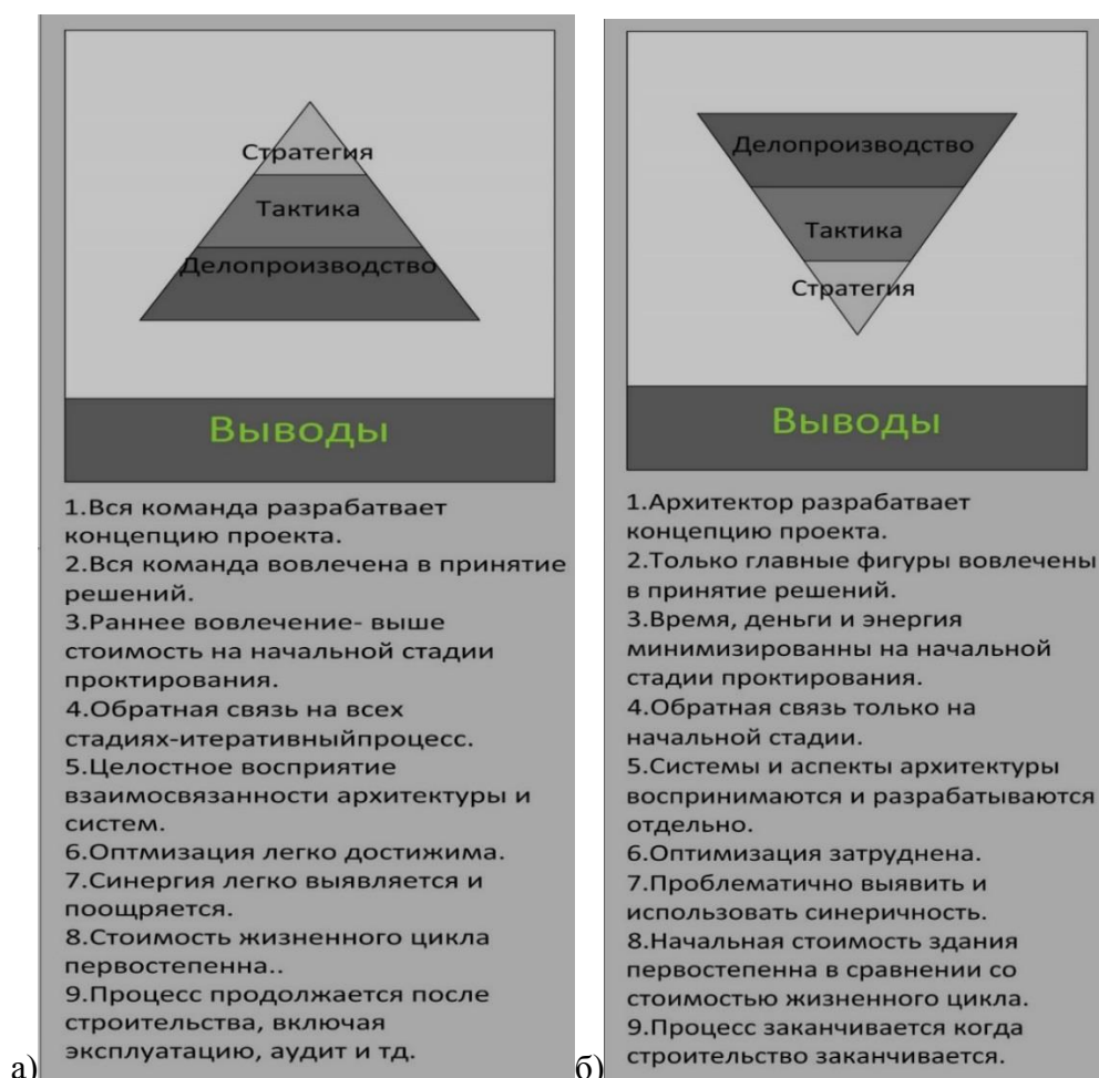
Рис.7. Выводы на основе анализа; а) Интегрированный процесс проектирования, б) Традиционный процесс проектирования
