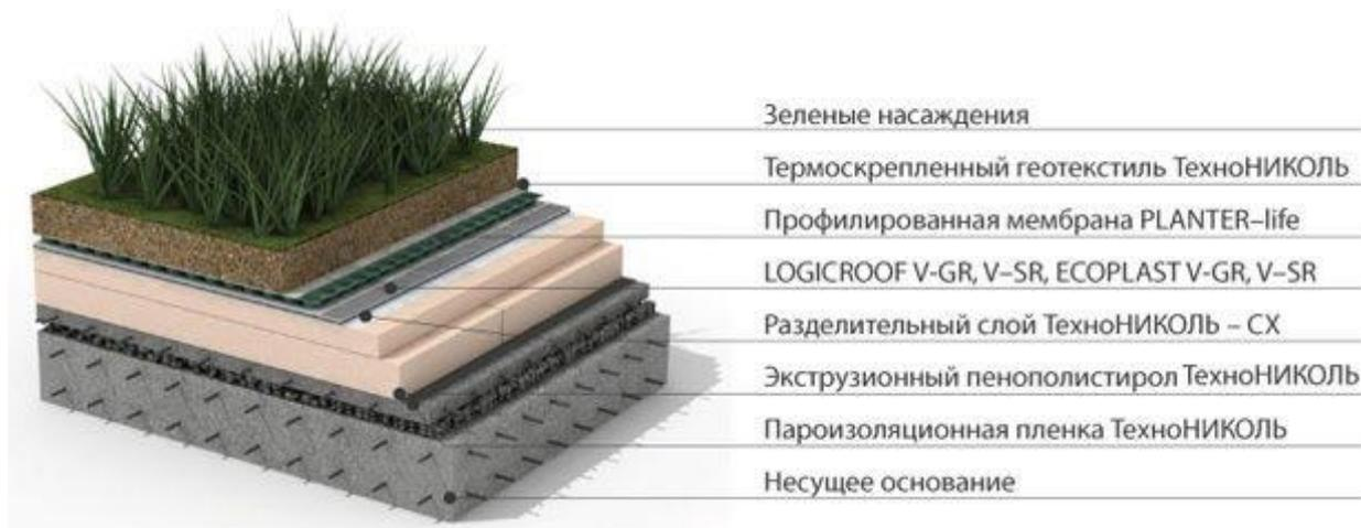
Рис. 2.4. Схема зеленой кровли
