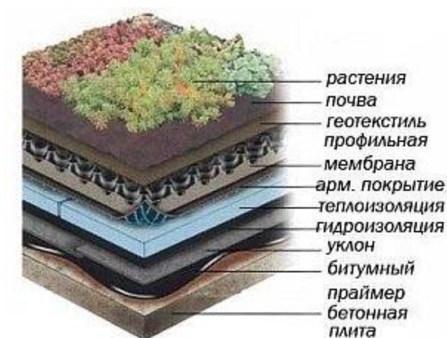
Рис.15 Разрез по эксплуатируемой кровле
