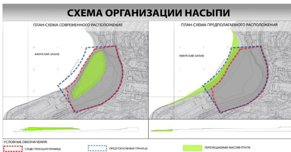
Рис. 7. Схема распределения грунта на территории для организации насыпи.
