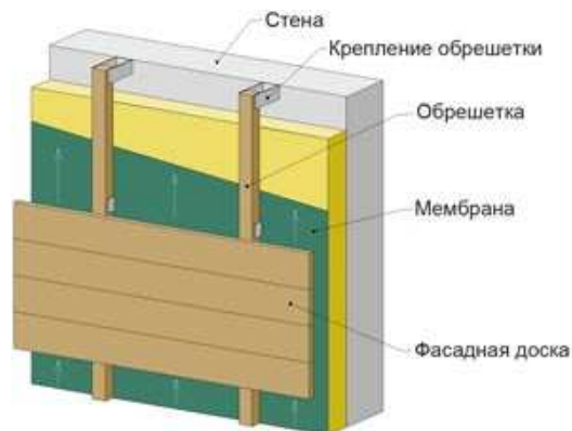
Рис. 2.4. Схема монтажа фасадной доски
