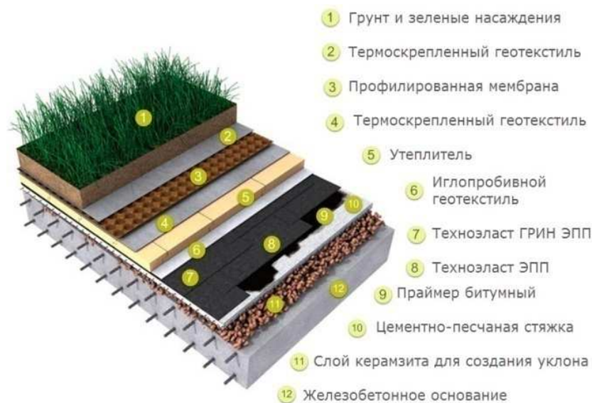
Рис. 2.2. Устройство эксплуатируемой кровли
