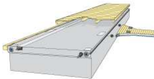
Рис. 1.9. Железобетонный плавучий понтон
