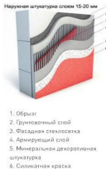
Рис. 2.4 –Схема нанесения слоев при оштукатуривании газобетона
