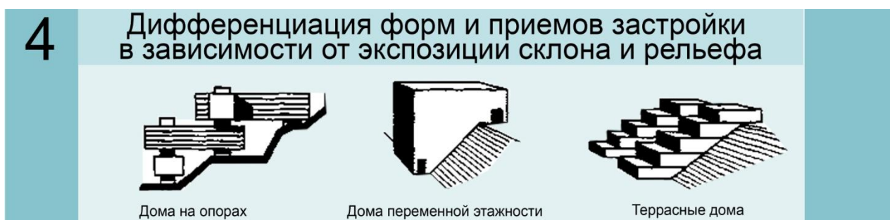
Рис. 49. Дифференциация форм и приемов застройки в зависимости от экспозиции склона и рельефа
