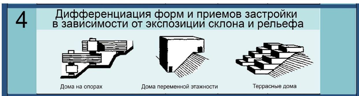
Рис.54. Принцип дифференциации форм и приемов застройки в зависимости от экспозиции склона и рельефа
