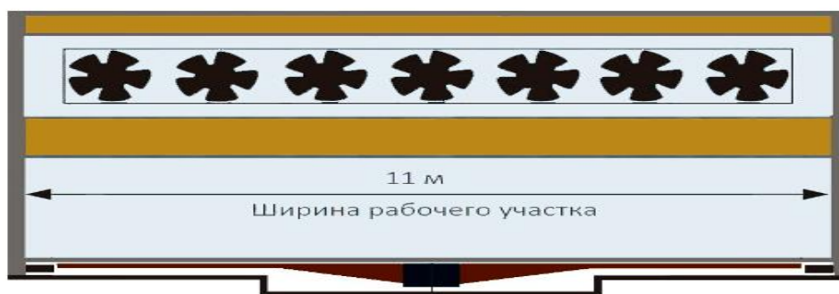
Рисунок 1.22 – Схема рабочего участка аэродинамической трубы
