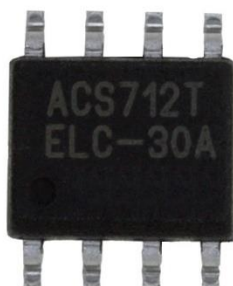
Рисунок 2.13 – Датчик тока на эффекте Холла ACS712ELCTR-30A-T
