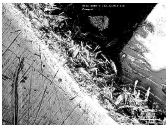
Рис. 1.1.1. Микроструктура зоны соединения I (OLYMPUS LEXT OLS 4100),  $T_g=800$  °C,  $t_g=100$  мин.
