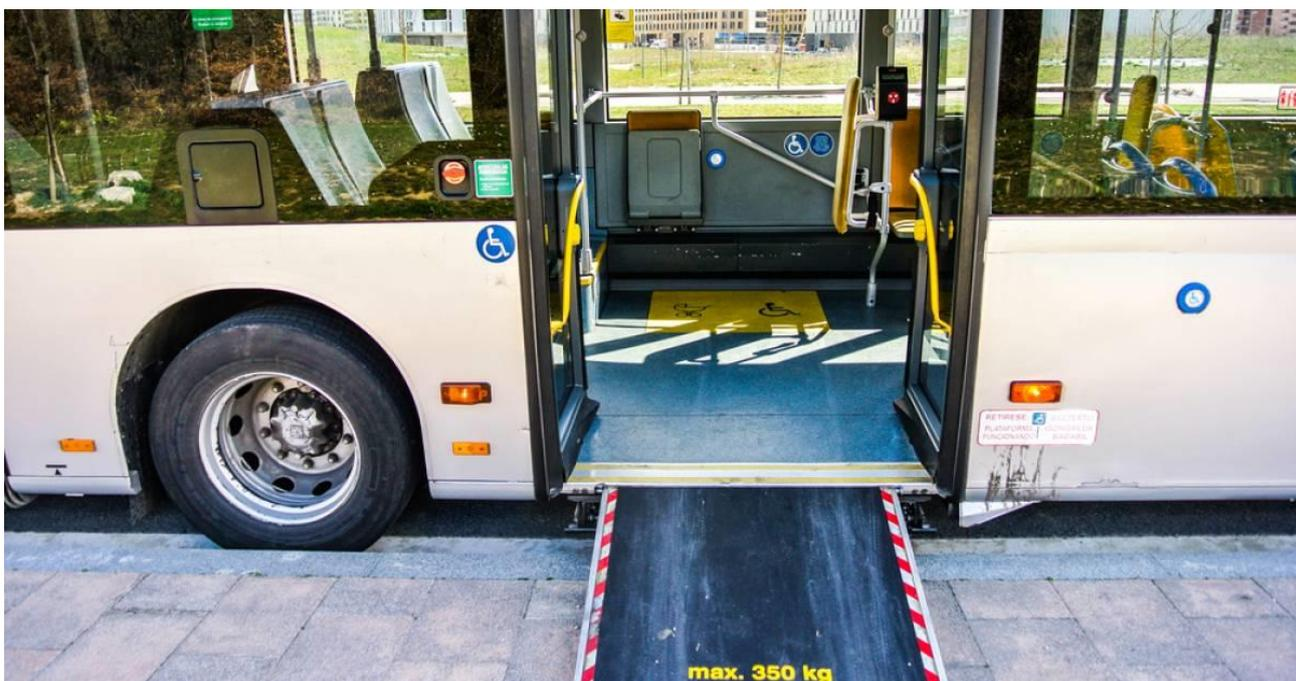
Рисунок 5 – Автобус, оборудованный специальным пандусом
