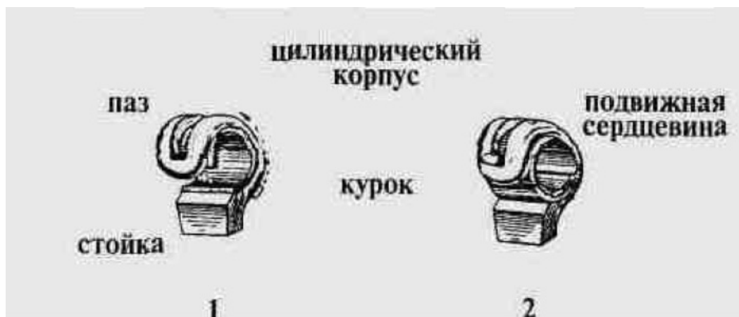
Рисунок 19 – Запирающее устройство визорного замка. 1 – открытое положение, 2 – закрытое положение
