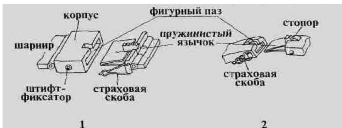
Рисунок 23 – Эскизы коробчатых замков с горизонтальной защелкой
