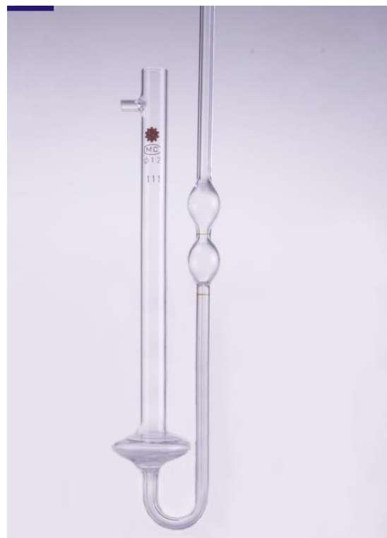
Рисунок 5 – Схема и изображение вискозиметра для измерения вязкости раствора
