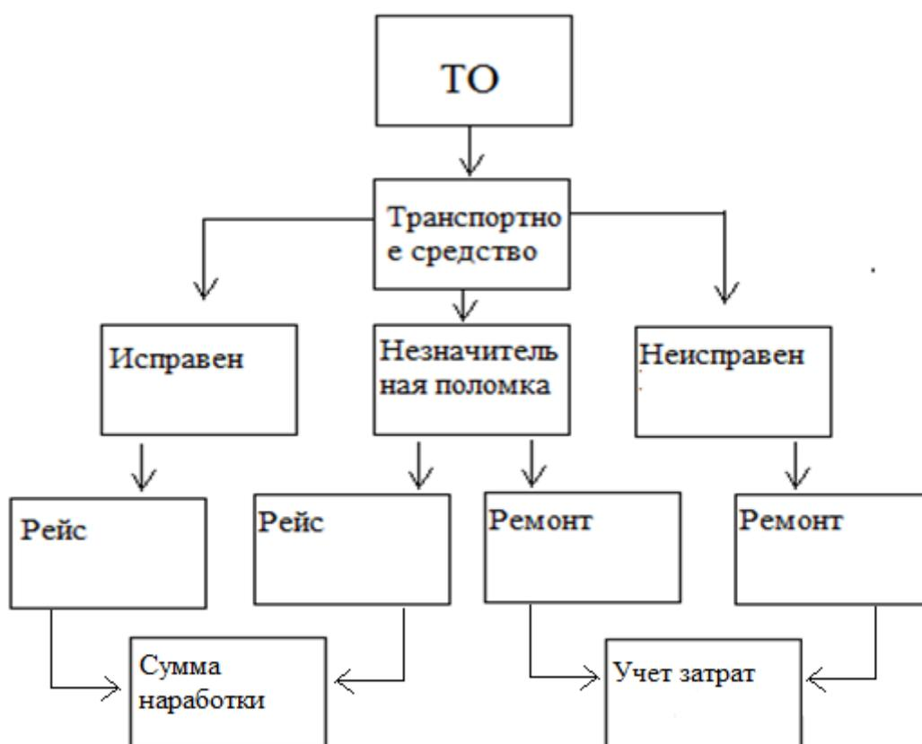
Рисунок 12 - схема прохождения ТО<sup>1</sup>
