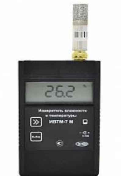
Рисунок 1.1.3 - Термогигрометр ИВТМ-7 М
