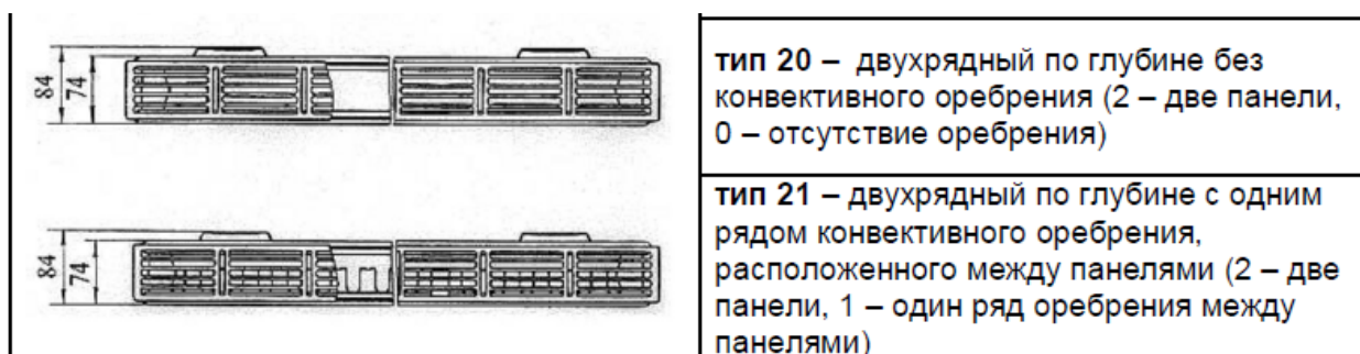
Рисунок 1.2 – типы стальных панельных радиаторов
